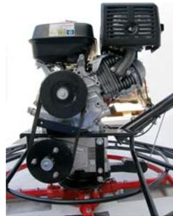
Вид центробежной муфты после снятия крышки
