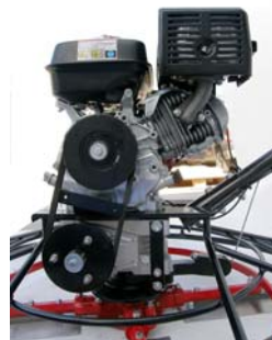
Вид центробежной муфты после снятия крышки
