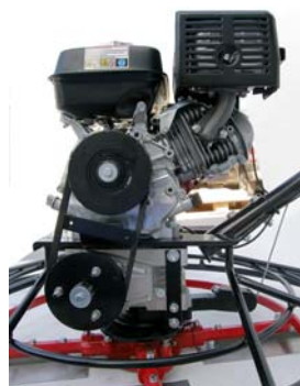
Вид центробежной муфты после снятия крышки
