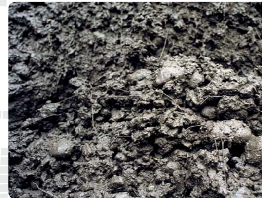
Mieszanie do równomiernego rozmieszczenia włókien stalowych BAUMIX® w mieszance betonowej.
