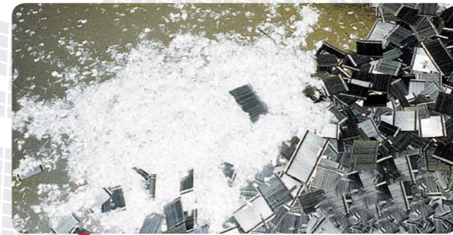
Wsypywanie włókien BAUMIX® wprost do kosza zasypowego jako dodatkowej frakcji kruszywa
