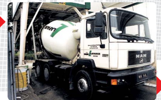
Napełnianie betonowozu betonem z włóknami stalowymi BAUMIX®
